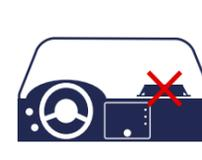
Installieren Sie den TRACK 1010 nicht auf dem Armaturenbrett des Autos. Die maximale Betriebstemperatur des Geräts würde sonst überschritten, was zu Schäden führt.
